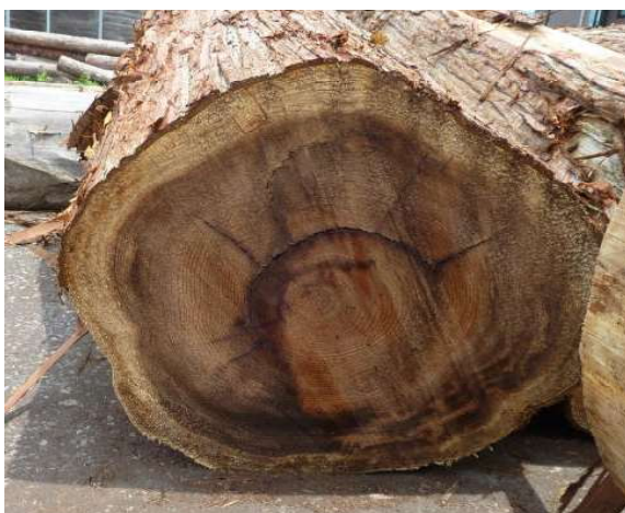
【写真8】「木口面の割れ」の例
