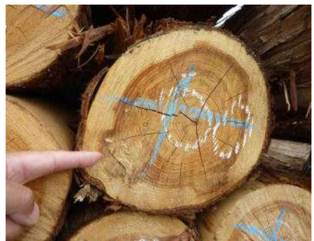
【写真9】「木口面の腐り」の例
