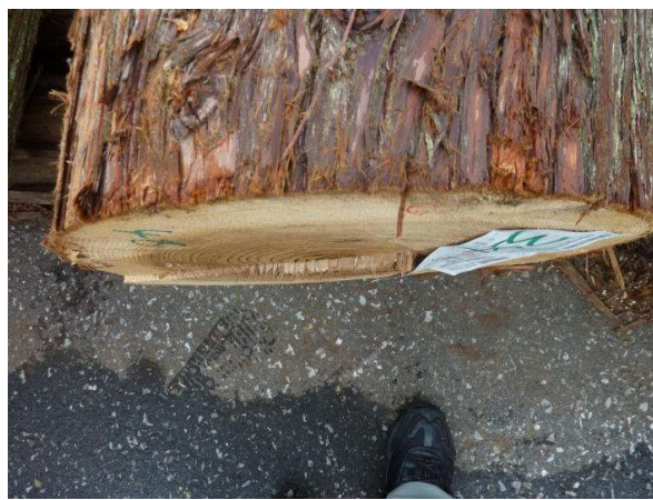
【写真6】「斜め切り」および 「木口面の段差」の例
