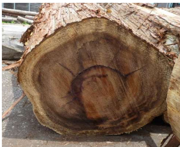
【写真8】「木口面の割れ」の例
