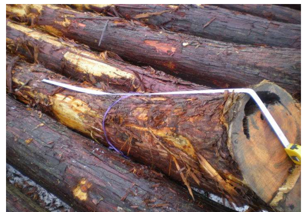
【写真4】 「ラッパ形状の材」の例
