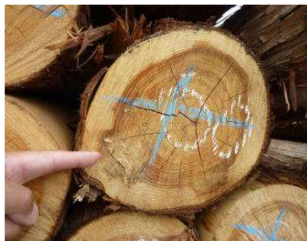
【写真9】「木口面の腐り」の例
