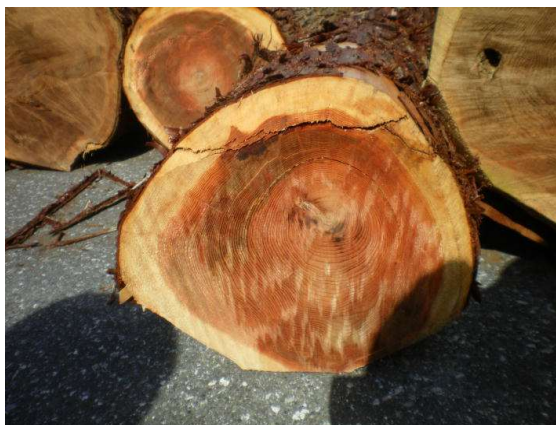
【写真1】伐倒時の衝撃による割れ
